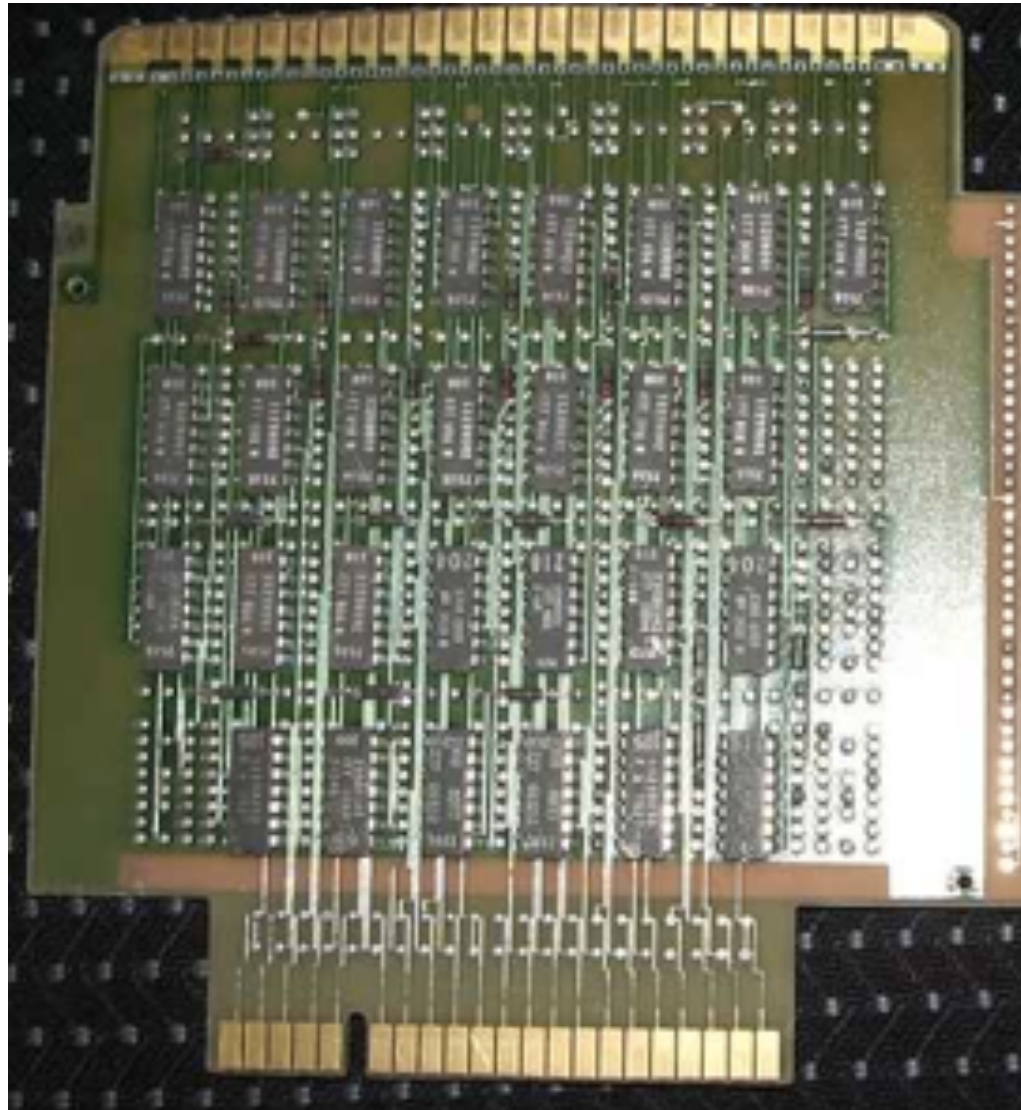
Scheda a circuiti integrati che realizza una funzione logica (o booleana) complessa
