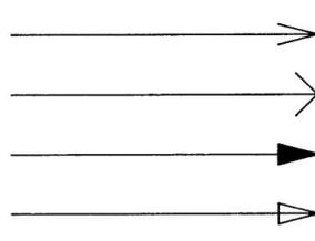
Le frecce, di norma, vanno poste internamente alle linee di riferimento. È possibile disporle esternamente quando richiesto per motivi di spazio. Per lo stesso motivo possibile sostituire le frecce con dei puntini.
