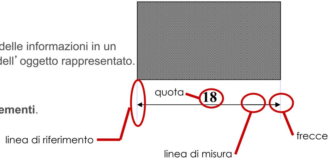
Una quota viene rappresentata da una linea di misura confinata tra due linee di riferimento. Le estremità della linea di misura sono evidenziate con frecce o tratti obliqui. Il valore numerico della quota (solitamente in **cm** per le dimensioni lineari, in **gradi** per quelle angolari) è sempre riferito alle dimensioni reali (indipendentemente dalla scala).
