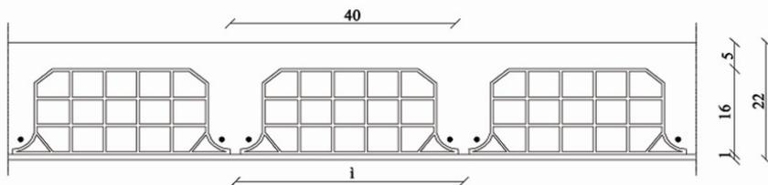
I travetti sono gettati in opera. La sagoma delle pignatte fornisce una cassaforma per il getto. L'intonaco all'intradosso del solaio ha un supporto continuo ed omogeneo
