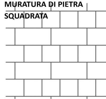
Composta con pietre di geometria pressoché parallelepipeda poste in opera a strati regolari. Lo spessore minimo deve essere 24 cm.
