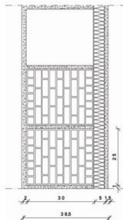
La collocazione dello strato termoisolante verso l'**interno** della parete ne DIMINUISCE L'INERZIA TERMICA
