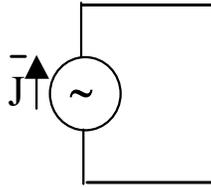
Fig. V.5 – Circuito monofase equivalente di un carico o di un generatore
