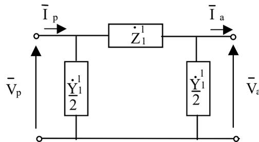
Fig. V.2. Circuito monofase equivalente di una linea corta
